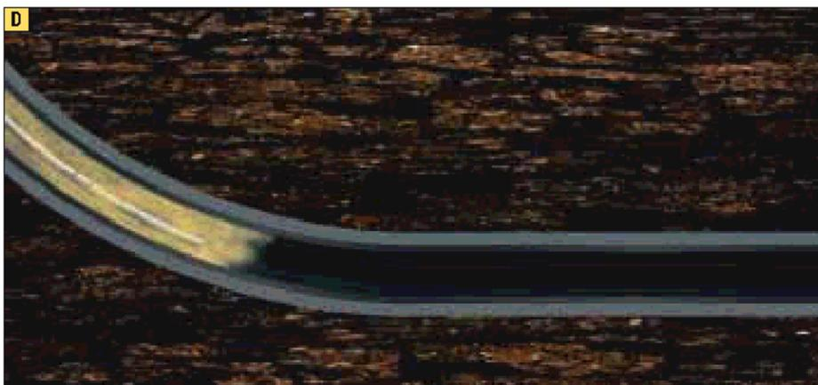
一旦堵塞物被驱扫到预定深度后，工具重新返回井下，再一次吃入堵塞物。不断重复该过程，直到所有堵塞物都被搅动并从井筒中清除出来(左图)。
